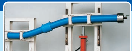
せん断試験で30cmの強制変位もクリア!
