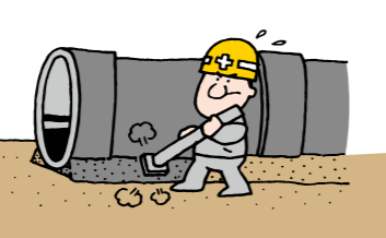
⑧ 管底側部のつき固め
