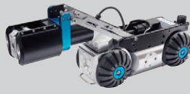
TVカメラ検査ロボット
