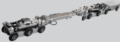
衝撃弾性波検査ロボット
