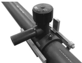
オール樹脂での融着一体化で高い耐震性。融着工具を使用しない場合や接合後すぐに水圧試験をする場合は、金属継手でも接合できます。
