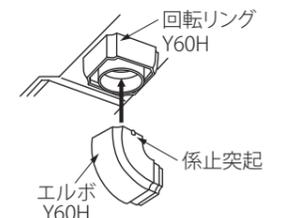
▲ 回転リングにエルボ、ソケットを取り付ける場合は係止突起がカチッと係止するまで押し上げてください。
