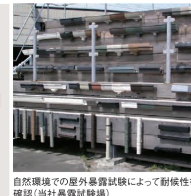
自然環境での屋外暴露試験によって耐候性を確認(当社暴露試験場)
