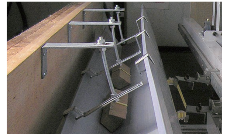
▼風圧荷重、積雪荷重実験 (建物3階相当の高さ(9m)で強風地域の2倍の風圧荷重を雨といに加え確認)
