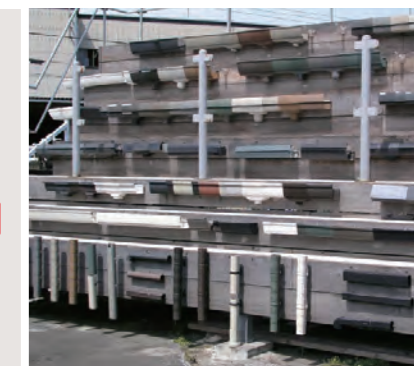
自然環境での屋外暴露試験によって耐候性を確認(当社暴露試験場)
