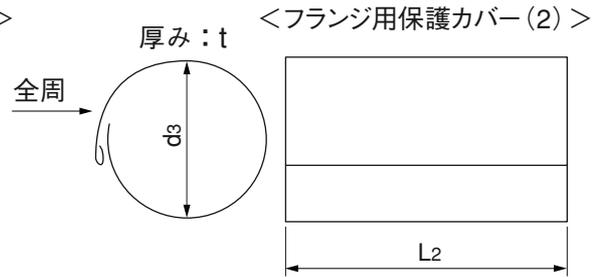
(備考) カラー鉄板：円周方向片端ムダ折り。呼び径200は管軸方向もムダ折り。
