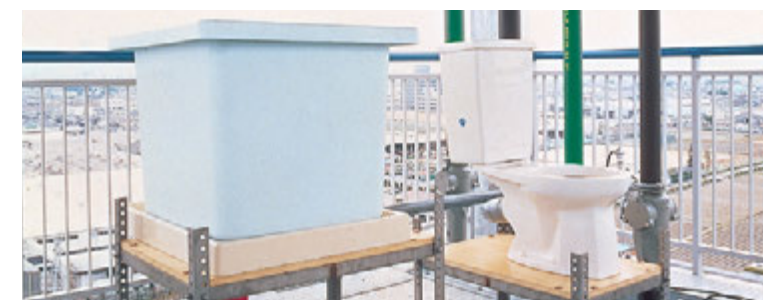
器具排水 実際に浴槽、便器を使用して器具排水を行った場合の、管内圧力変動を測定することができます。
