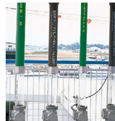
立て管・継手 継手にはADスリム継手を、立て管にはDVLVの管を用いており、排水流下状況の確認、および管内圧力変動の測定ができます。
