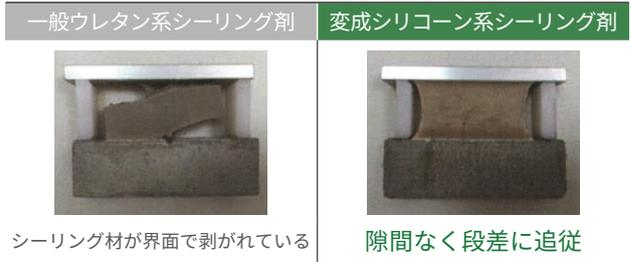
[測定条件] シーリング材施工後隙間の幅を2倍に広げて評価
