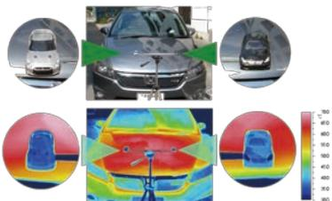
車とミニカーの表面温度の比較実験とサーモグラフィ映像
