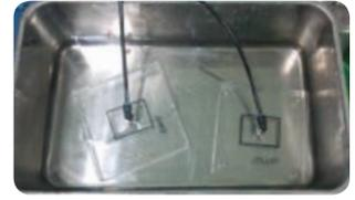
テープの周りを水で満たし空気が漏れ出すまでの時間を測定
