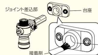
台座の取付穴に塩ビ管用接着剤を塗布し、ジョイント差込部を差し込んで接続してください。
