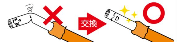
**注意** ●管は継手や支持部材を支点に曲げないでください。また急激な力を加えた曲げ加工はしないでください。管・継手が破損するおそれがあります。
