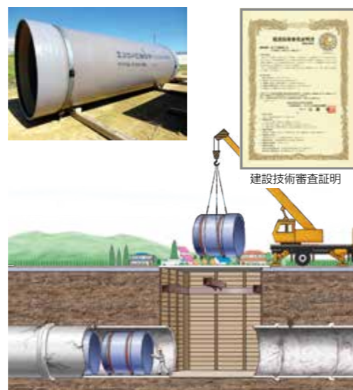
老朽管の中の運搬は、車輪付きバンドを管本体にセットし、人力で行います。
