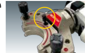
× プレスダイス固定ピン挿入不完全
