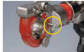
× プレスダイス固定ピン挿入不完全
