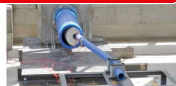
架空配管による水平変位実験 (UR都市機構3次元振動台)
