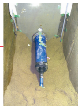
埋設沈下実験 (独)土木研究所内土槽
