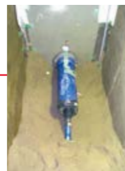
埋設沈下実験 (独)土木研究所内土槽
