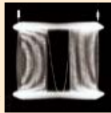
●EF継手に組込まれた電熱線
