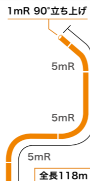
継手のないライナー材で一体管路に
