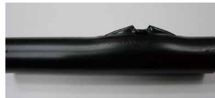
夏場の水圧試験時の破裂事故例
