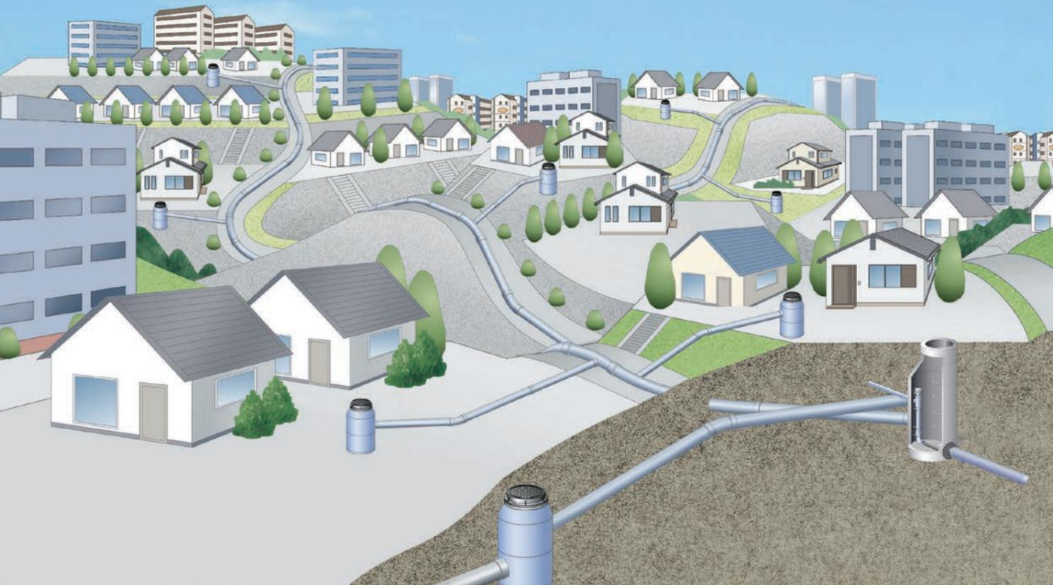
地形変化に強い圧力式・圧送式下水道。
