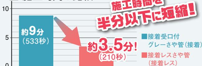
※当社施工実験による (ボディ管φ250内に設置した、さや管φ50×8条・φ30×6条を1断面接続した時の施工時間)
