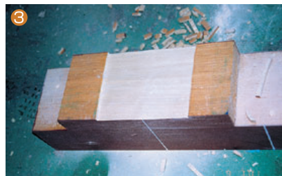
●表面仕上げ完了
