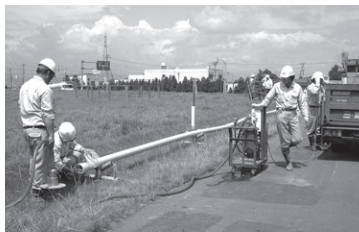
真空気密試験の様子
