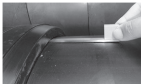
ゲージによる隙間寸法の確認
