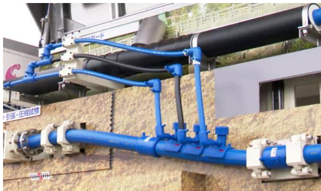
キャラバンカーによるせん断、引張・圧縮試験
