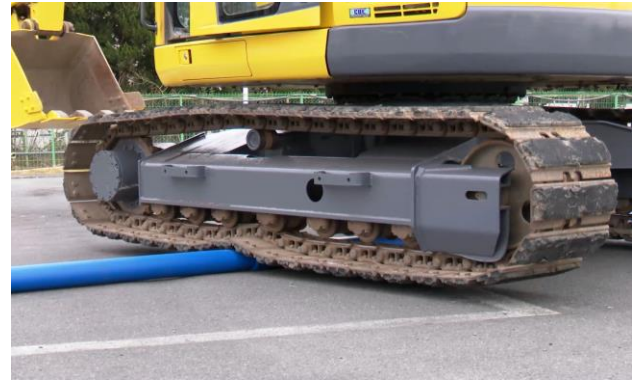
10tバックホーによる管体の強度確認
