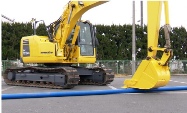
バケットによる耐衝撃性確認
