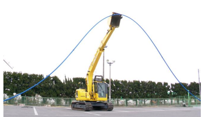
吊り上げによる管の柔軟性確認(呼び径50mm)
