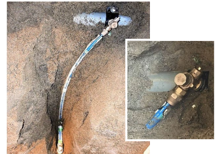
埋設実験では、実際に配管した給水装置引込み部に強制変位を与え、性能を評価
