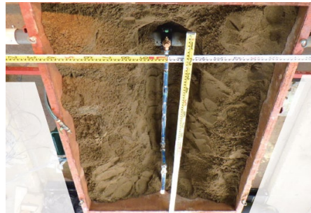
埋設実験では、実際に配管した給水装置引込み部に強制変位を与え、性能を評価
