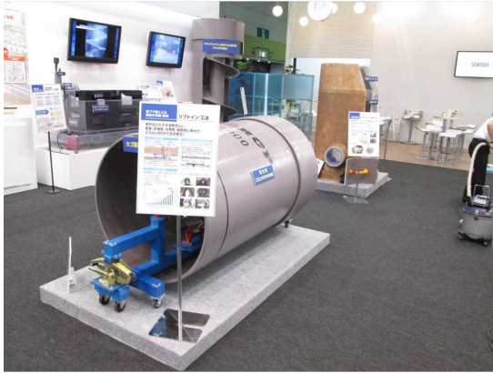
(手前)リフトイン工法 (奥側)PPS マンホール更生工法
