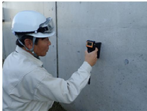
図 4.5.3 コンクリート水分量の計測状況
